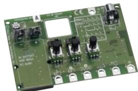
**EESX306A** Инструмент для демонстрации. Гибкий инструмент для обучения и показа работы порядка работы осциллографа. Подходит для любого осциллографа. Показывает хорошую форму волны, плохую форму и сбой. Квадратную волну, переменную нагрузку, рисунок FI, сигнал переменного напряжения, рисунок вторичного зажигания. Регулируемая частота, напряжение, обороты и амплитуда.
