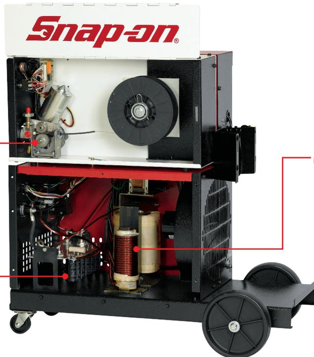
Вся обмотка выполнена из меди, а на отводах трансформатора установлена изоляция Nomex и ламинация на болтах, что позволяет очень точно управлять напряжением и делать одинаковые швы.
